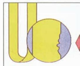
Controllare l'integrità delle fasce prima di ogni utilizzo
