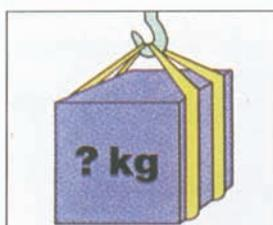
Controllare il peso del carico
