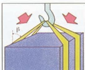
Tenere conto del modo di imbragaggio e dell'angolo d'inclinazione
